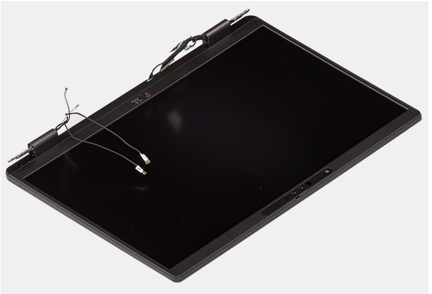
Abbildung 3. Bildschirmbaugruppe mit WWAN-Antennenkabeln
