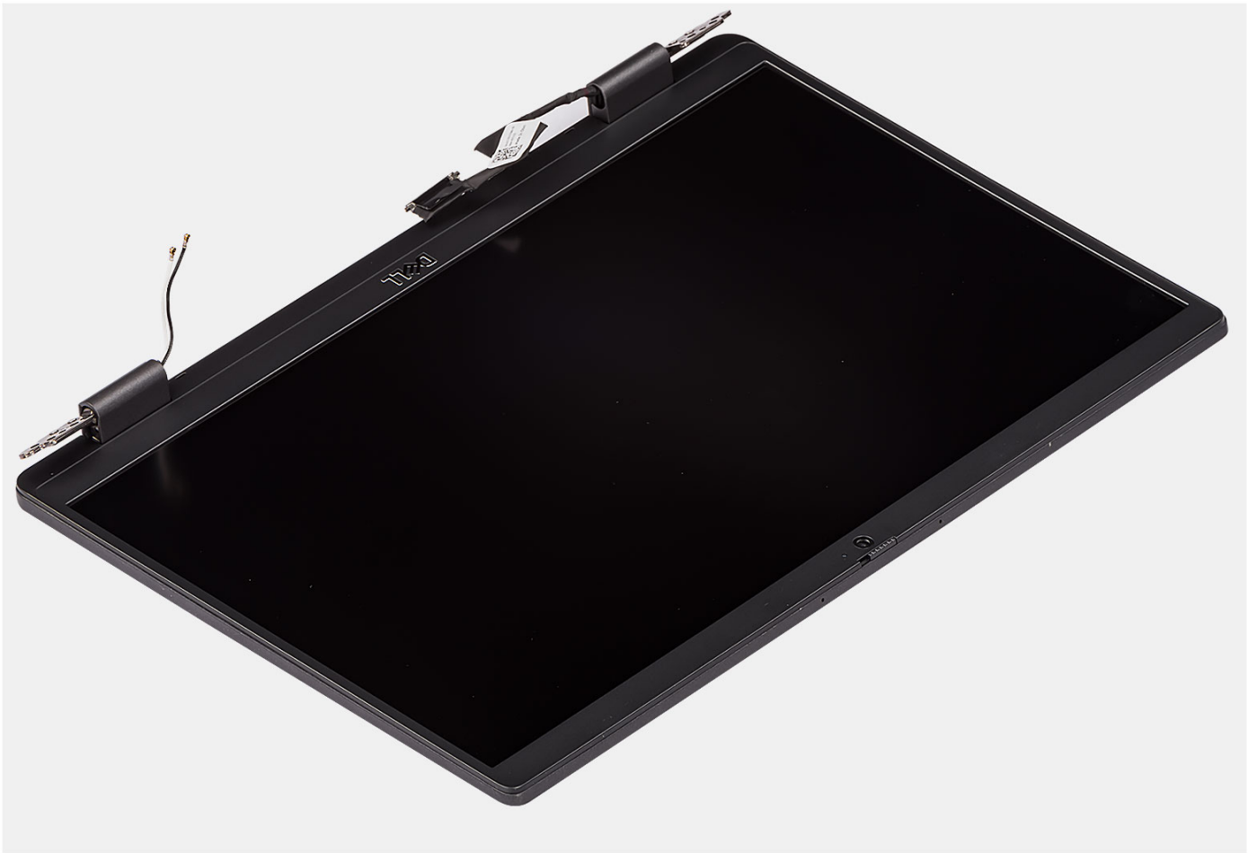
Abbildung 2. Bildschirmbaugruppe ohne WWAN-Antennenkabel
