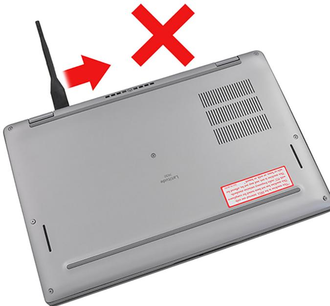
**VORSICHT:** Hebeln Sie nicht an der Kante in der Nähe der Lüftungsschlitze oben auf der Bodenabdeckung nach oben, da dies die Bodenabdeckung beschädigen könnte.
