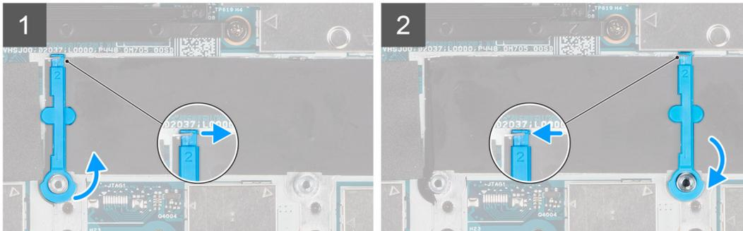
Die Abbildung stellt das Ersetzen eines M.2-2230-Solid-State-Laufwerks durch ein M.2-2280-Solid-State-Laufwerk bildlich dar.
