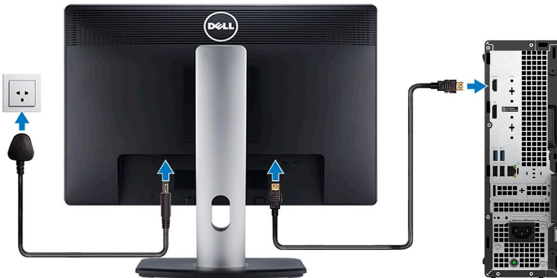
4. Schließen Sie das Stromkabel an.
