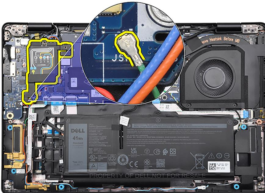
16. Entfernen Sie die drei Schrauben (M2x2,5), die zwei Schrauben (M2x4) und die zwei Schrauben (M2x3) zur Befestigung der Hauptplatine an der Handauflagen- und Tastaturbaugruppe.
