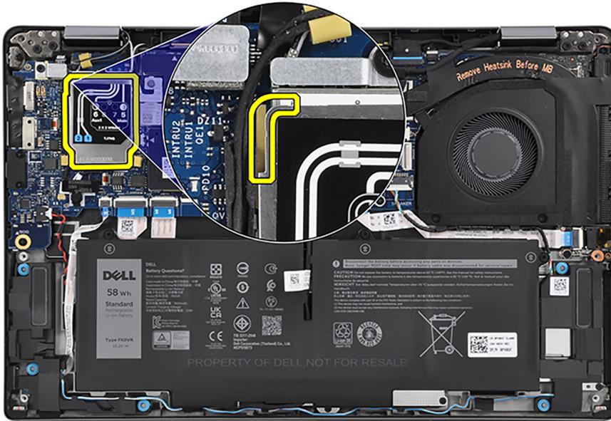
2. Entfernen Sie die Schraube (M2x2,5), mit der die 4G-WWAN-Kartenhalterung an der Hauptplatine befestigt ist.
