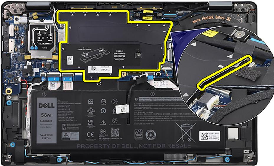
2. Trennen Sie das Lüfterkabel vom Anschluss auf der Hauptplatine.
