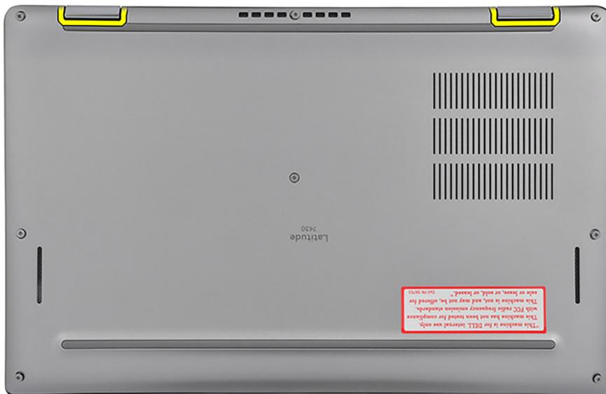
**VORSICHT:** Schieben Sie den Kunststoffstift nicht entlang der Kanten an der Oberseite der Bodenabdeckung. Dadurch würden die Laschen der Bodenabdeckung beschädigt.
