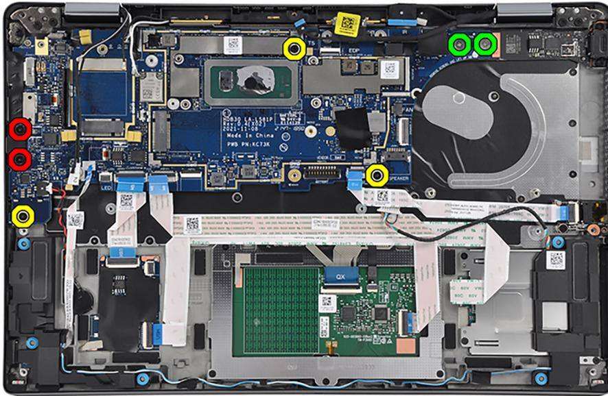
17. Bringen Sie die vier Schrauben (M2x2,5), die zwei Schrauben (M2x4) und die zwei Schrauben (M2x3) zur Befestigung der Hauptplatine an der Handauflagen- und Tastaturbaugruppe wieder an.
