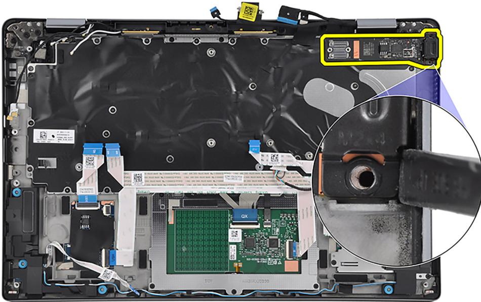
3. Heben Sie die E/A-Tochterplatine von der Handauflagen- und Tastaturbaugruppe und entfernen Sie sie.
