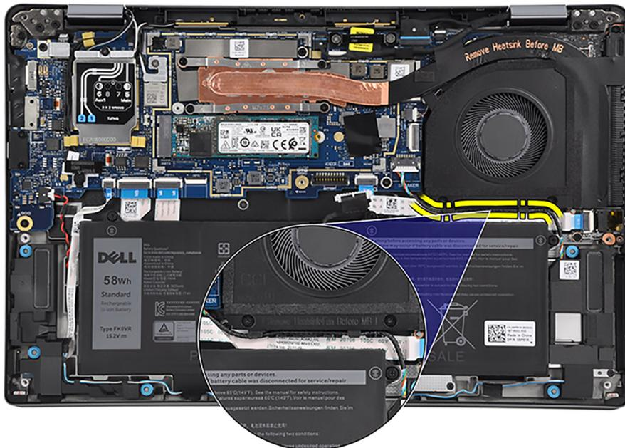
5. Verbinden Sie das Kabel des Lautsprechers mit dem Anschluss auf der Hauptplatine.
