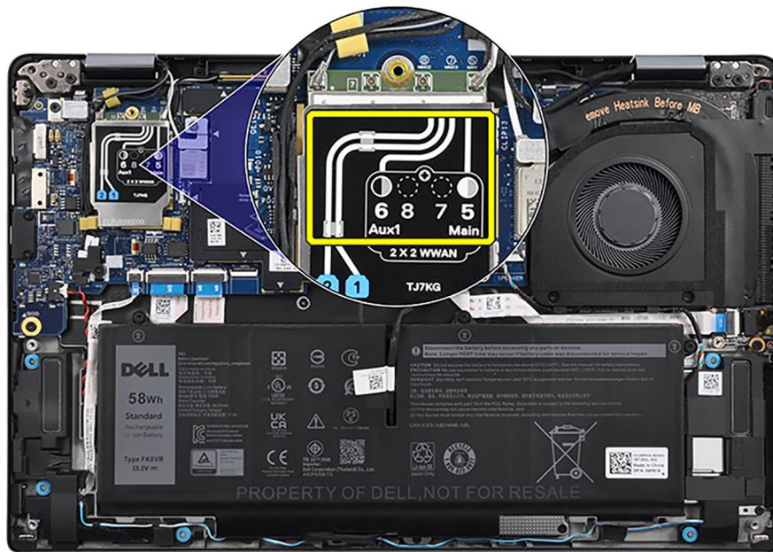
**Abbildung 1. 4G WWAN-Konfiguration**
