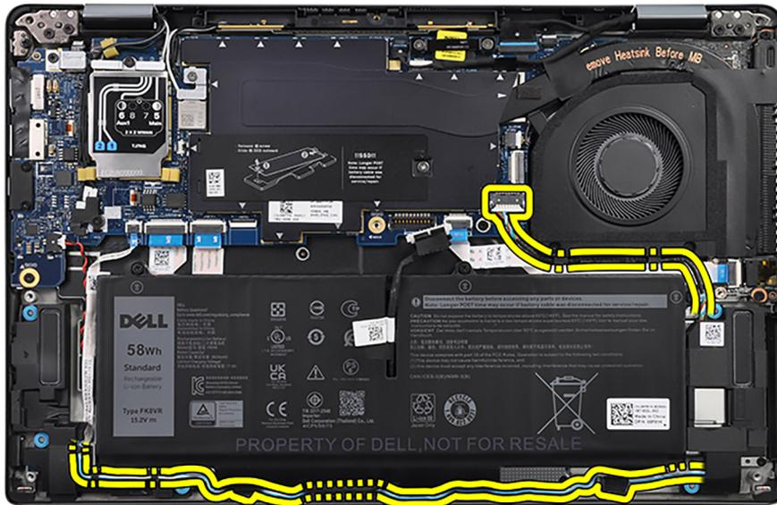
4. Verbinden Sie bei Systemen mit 5G-Antennen das P-Sensorkabel und das Lautsprecherkabel mit den entsprechenden Anschlüssen auf der Hauptplatine.
