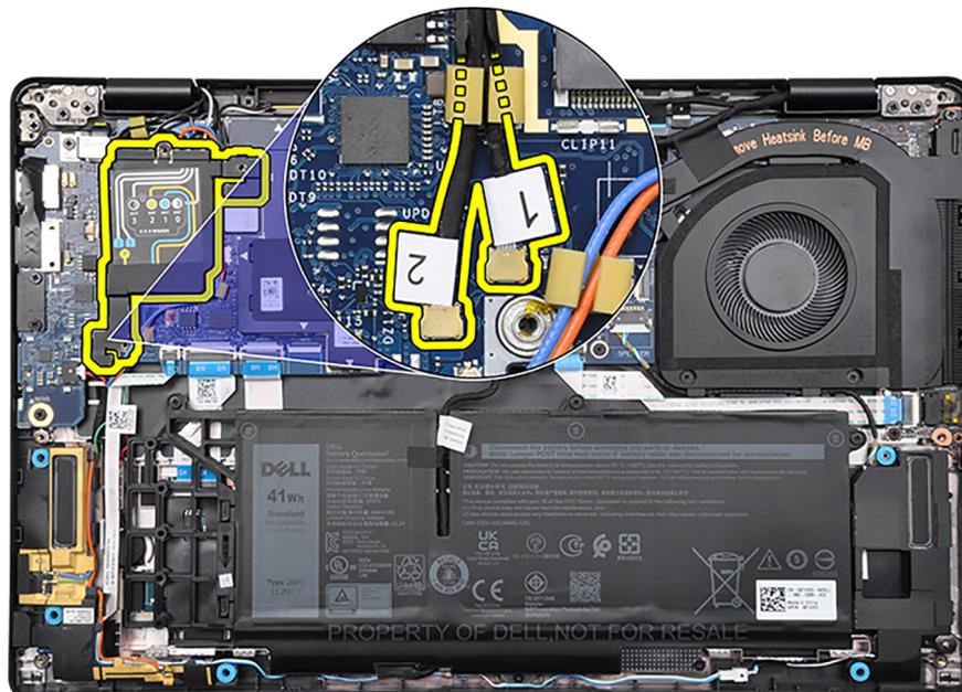
**Abbildung 5. 5G WWAN-Konfiguration**
