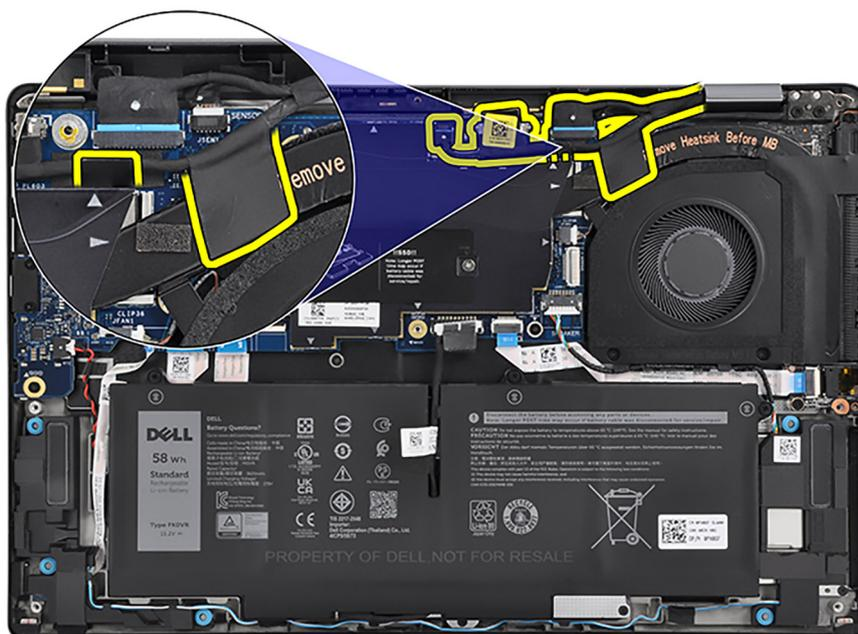
7. Richten Sie die Halterung des Bildschirmkabels aus und setzen Sie sie in den Steckplatz auf der Hauptplatine.
