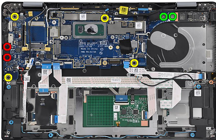
18. Lösen Sie die Knopfzellenbatterie mithilfe eines Kunststoffstifts aus der Handballenstützen- und Tastaturbaugruppe.
