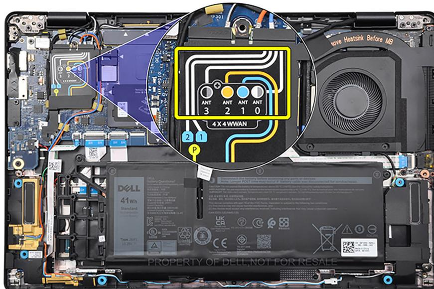
Abbildung 2. 5G WWAN-Konfiguration
