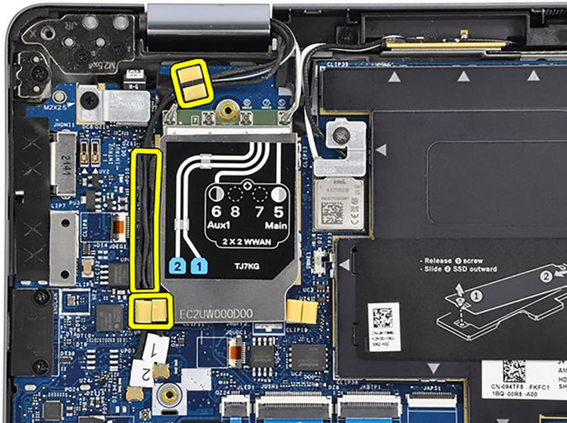
11. Verbinden Sie das Darwin-Antennenkabel Nr. 1 und das Darwin-Antennenkabel Nr. 2 mit den jeweiligen Anschlüssen auf der Hauptplatine.
