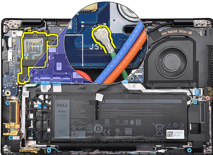
5. Verbinden Sie bei Systemen mit 4G-Antennen das Lautsprecherkabel mit dem Anschluss auf der Hauptplatine.
