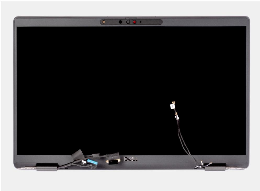
Abbildung 3. Bildschirmbaugruppe mit WWAN-Antennenkabeln
