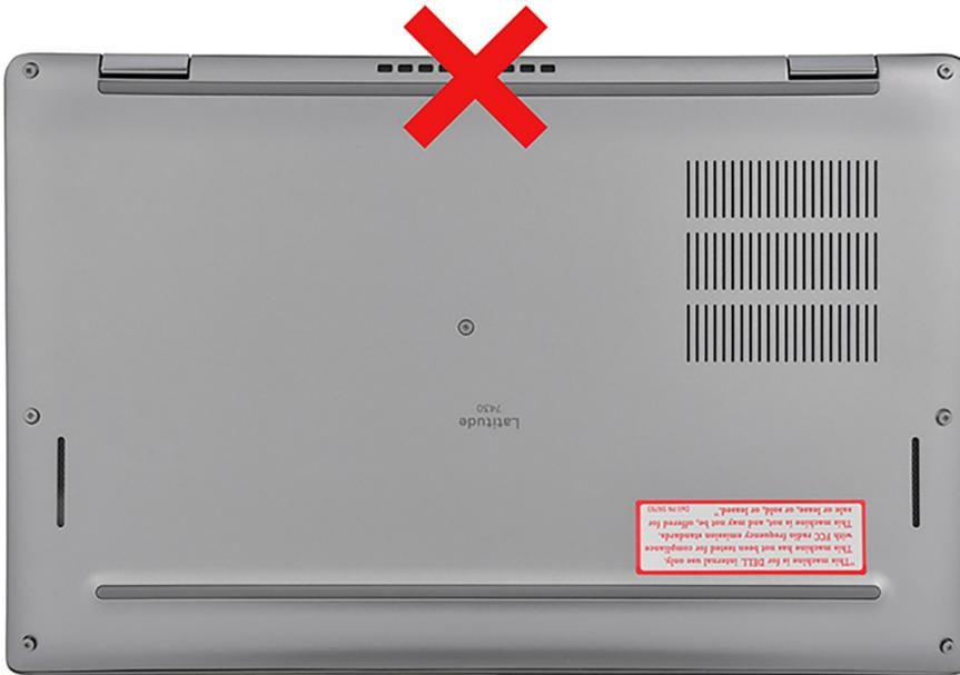
3. Hebeln Sie die Oberseite der Bodenabdeckung auf und arbeiten Sie sich auf der linken, rechten und unteren Seite weiter vor, um die Bodenabdeckung zu öffnen.
