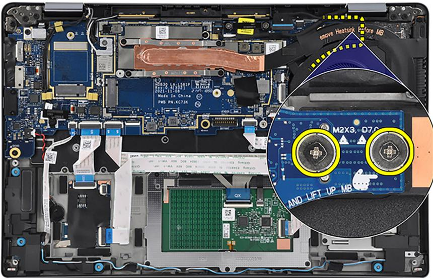
Die nachfolgenden Abbildungen zeigen die Position der Systemplatine und bieten eine visuelle Darstellung des Verfahrens zum Entfernen.
