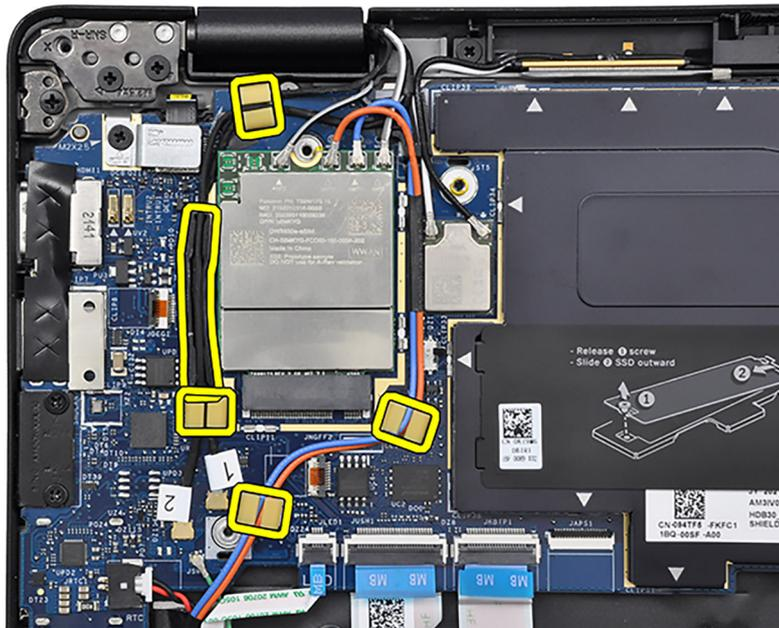
15. Verlegen Sie bei Computern mit 4G-Antennen das Darwin-Antennenkabel Nr. 1, das Darwin-Antennenkabel Nr. 2, das schwarz/grau WWAN-AUX1-Antennenkabel Nr. 6 und das weiß/grau WWAN-Hauptantennenkabel Nr. 5 in den entsprechenden Kabelführungen auf der Handauflagen- und Tastaturbaugruppe.
