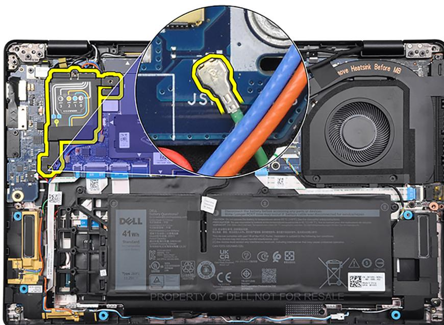
5. Lösen Sie das Klebeband, mit dem das Lautsprecherkabel an der Handauflage und am Touchpad befestigt ist.
