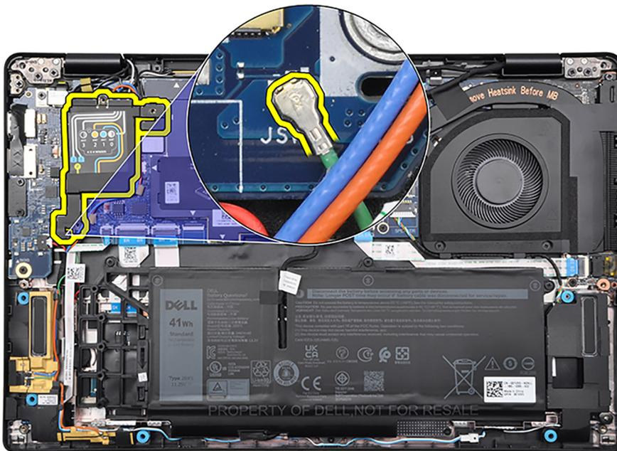
8. Bringen Sie das Klebeband zur Befestigung des Bildschirmkabels an der Hauptplatine an.
