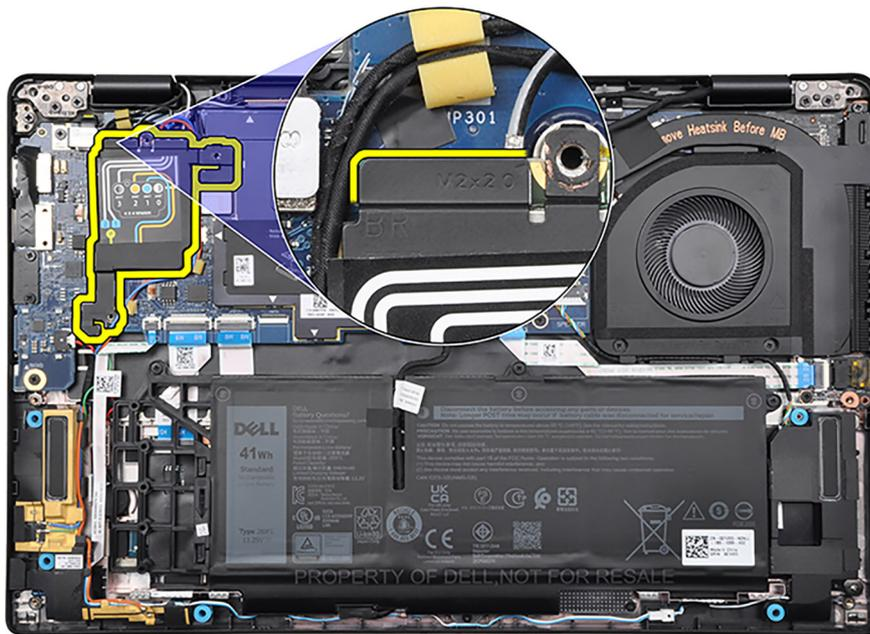
3. Trennen Sie die Antennenkabel von den Anschlüssen auf der 5G-WWAN-Karte.
