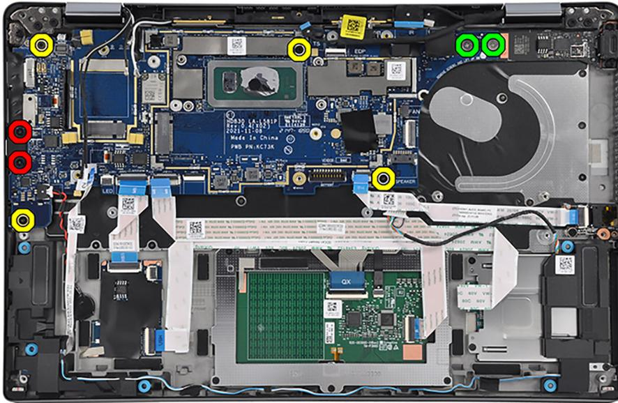
6. Bringen Sie die drei Schrauben (M2x2,5), die zwei Schrauben (M2x4) und die zwei Schrauben (M2x3) zur Befestigung der Hauptplatine an der Handauflagen- und Tastaturbaugruppe wieder an.
