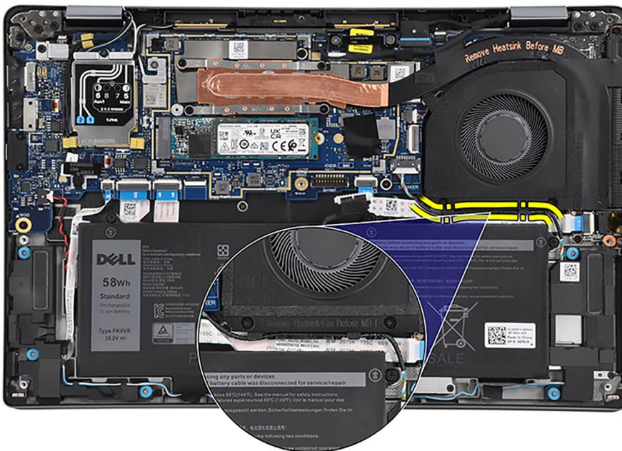
5. Entfernen Sie die zwei Schrauben (M2x2.5), mit denen der Lüfter befestigt ist, und die vier Schrauben (M2x2.5), mit denen der Kühlkörper an der Hauptplatine befestigt ist.
