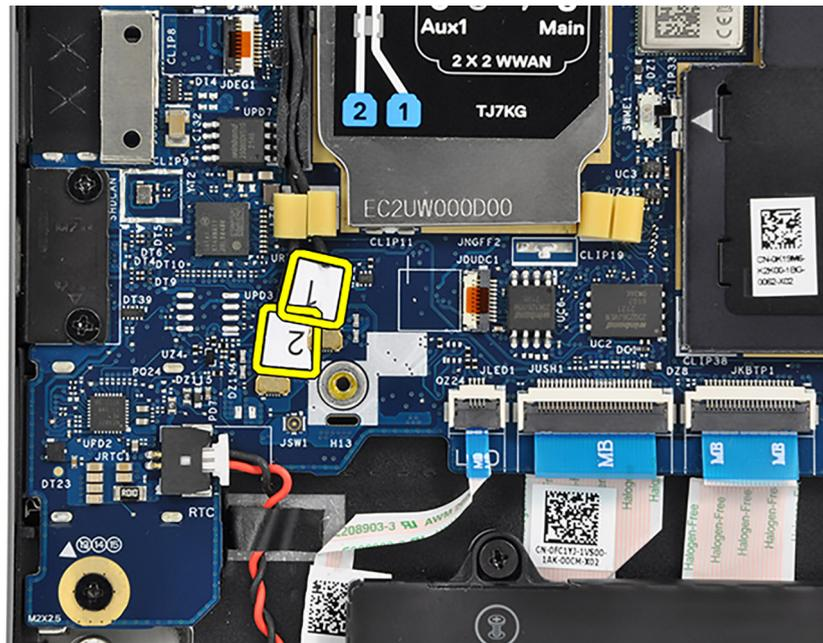
Abbildung 6. 4G WWAN-Konfiguration
