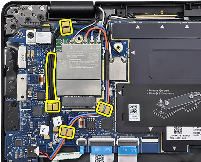
10. Verlegen Sie bei Computern mit 4G-Antennen das Darwin-Antennenkabel Nr. 1, das Darwin-Antennenkabel Nr. 2, das schwarz/grau WWAN-AUX1-Antennenkabel Nr. 6 und das weiß/grau WWAN-Hauptantennenkabel Nr. 5 in den entsprechenden Kabelführungen auf der Handauflagen- und Tastaturbaugruppe.
