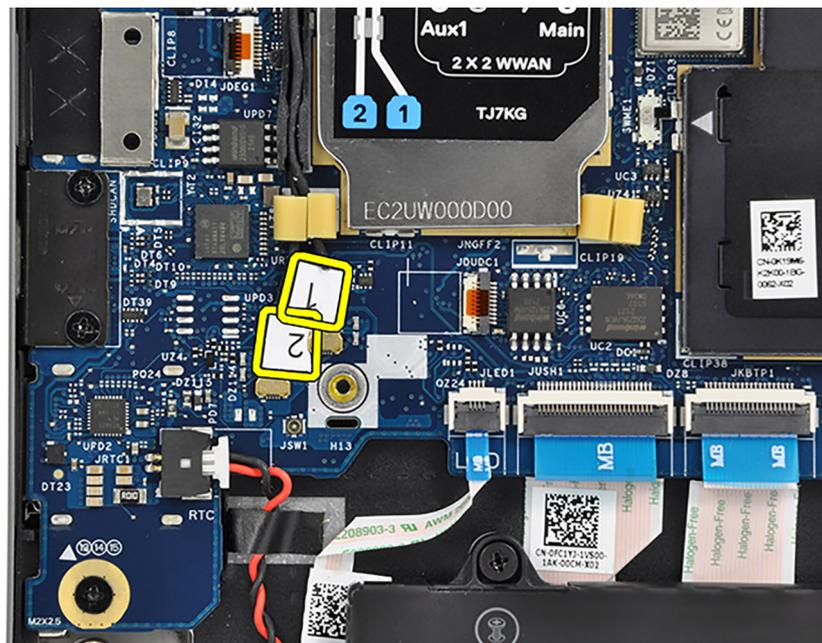
Abbildung 4. 4G WWAN-Konfiguration
