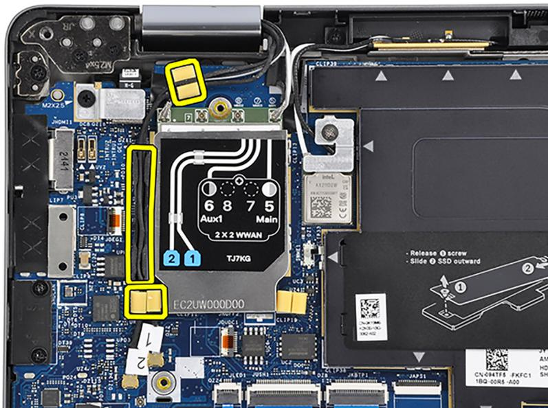
16. Verbinden Sie das Darwin-Antennenkabel Nr. 1 und das Darwin-Antennenkabel Nr. 2 mit den jeweiligen Anschlüssen auf der Hauptplatine.
