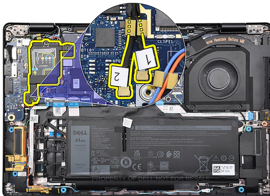
Abbildung 7. 5G WWAN-Konfiguration
