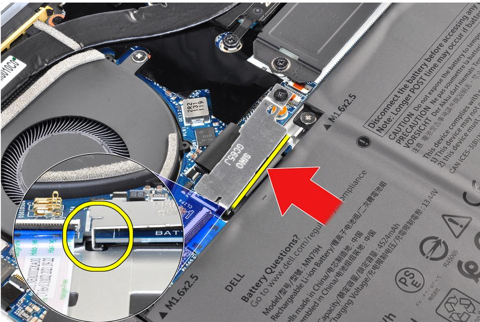
3. Utilisez la languette de retrait située sur le câble d'alimentation de la batterie pour déconnecter le câble de la batterie du connecteur de la batterie.
