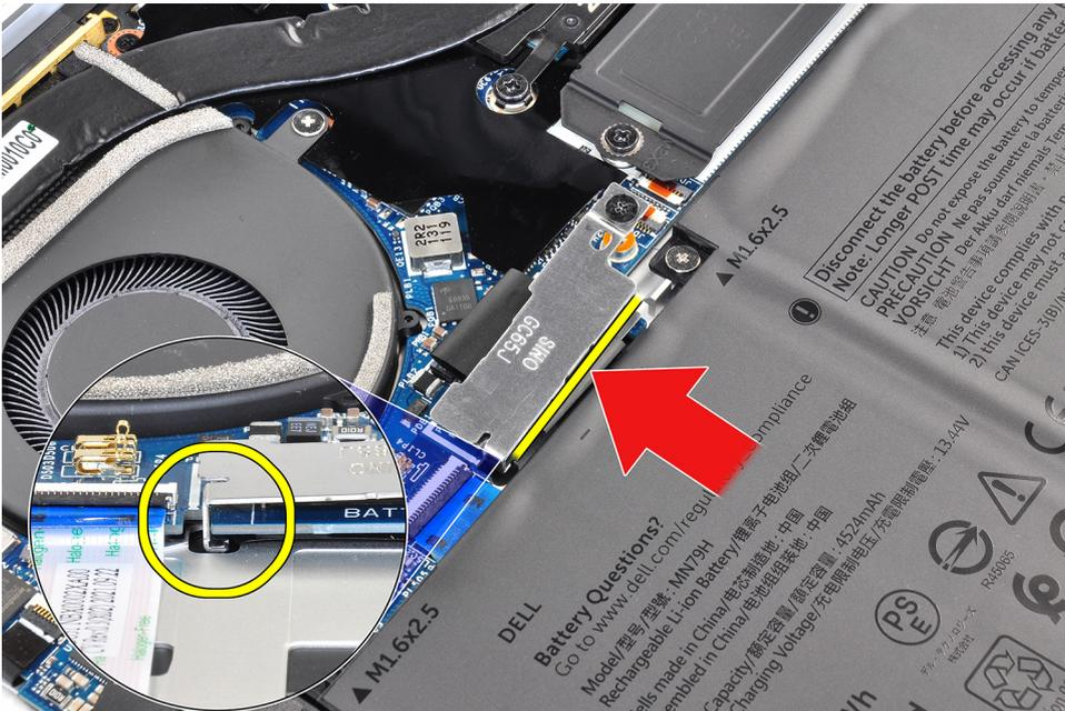
7. Serrez la vis imperdable du support sur la carte système et assurez-vous que le goujon situé sur la carte système s'insère dans son ouverture sur le support du connecteur de la batterie.
