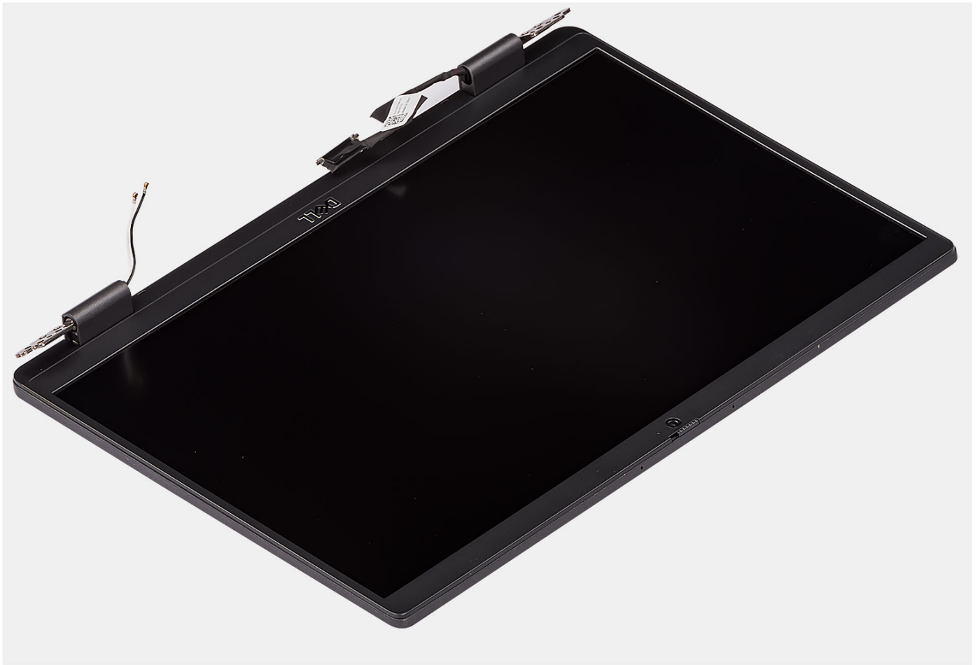
Figure 2. Assemblage d'écran sans câble d'antenne WWAN
