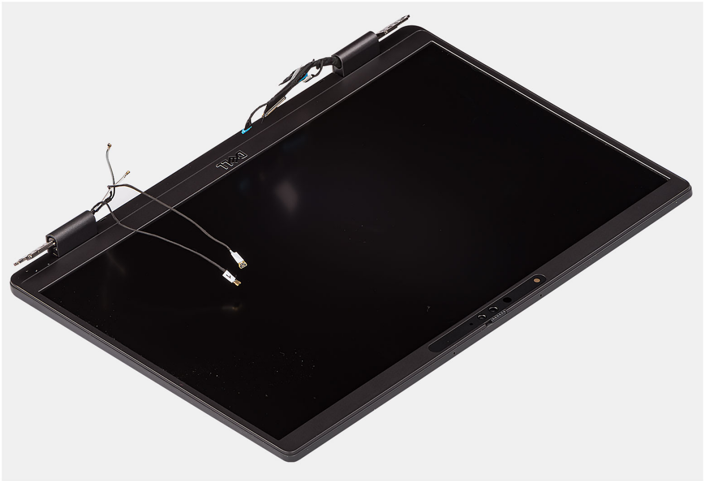
Figure 3. Assemblage d'écran avec câbles d'antenne WWAN
