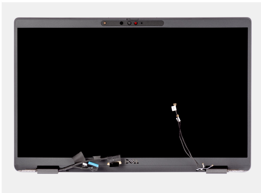
Figura 3. Gruppo del display con cavi dell'antenna WWAN
